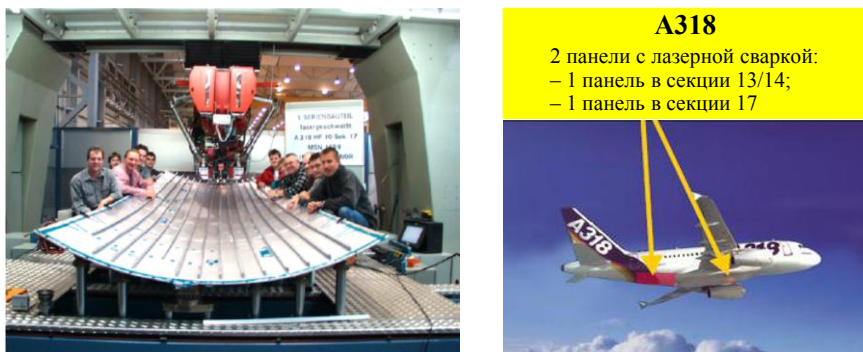
Рис. 3. Нижняя сварная панель фюзеляжа самолета A318 (секция 17) компании Airbus в сварочном цеху компании Premium AEROTEC
