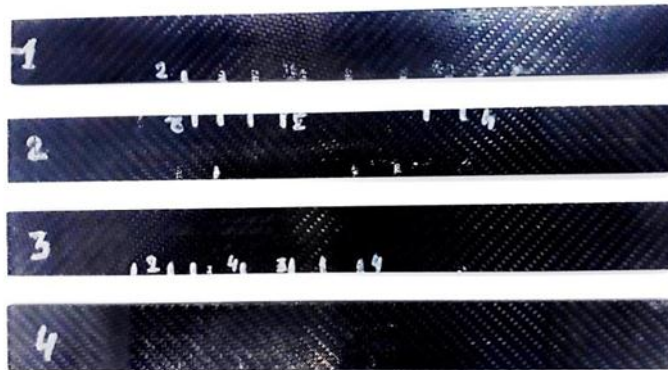
Рис. 1. Образцы из углепластика для испытаний на малоцикловую усталость и ультразвуковых исследований
