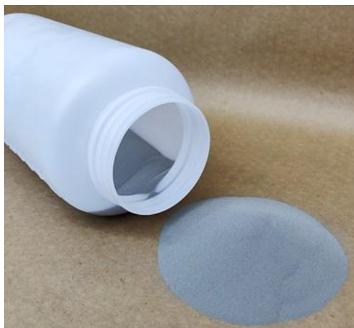
Рис. 1. Металлопорошковая композиция из сплава марки ВСДП-3 в состоянии свободной насыпки
