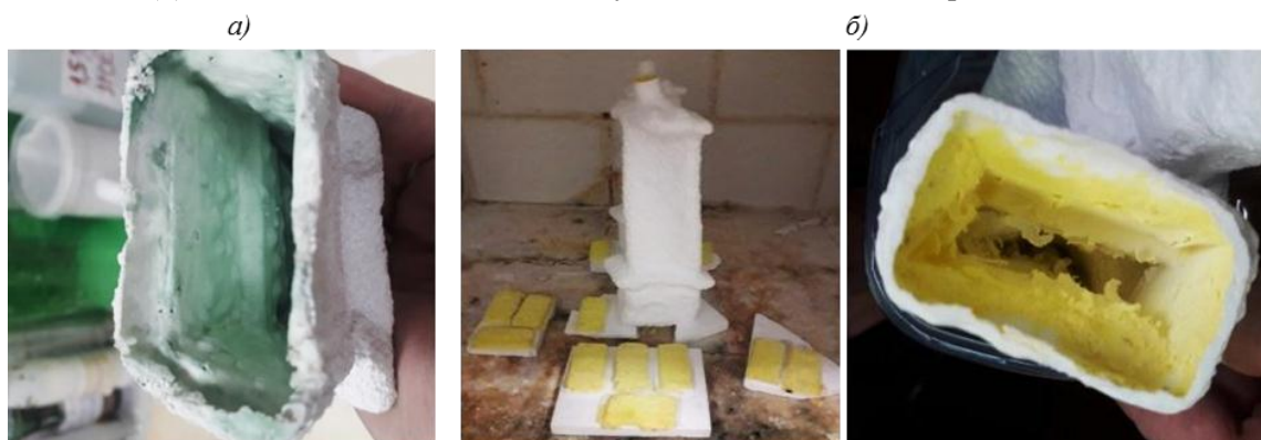
Рис. 4. Общий вид керамической формы после удаления модельной композиции (а) и после высокотемпературного обжига (б)
