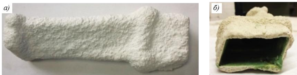
Рис. 6. Общий вид керамической формы, изготовленной на основе связующего золь оксида алюминия, прототипа лопатки до удаления восковой композиции (а) и после удаления модельной композиции (б)
