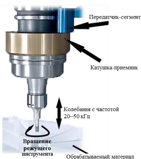
Рис. 4. Принцип технологии ультразвуковой обработки ULTRASONIC
