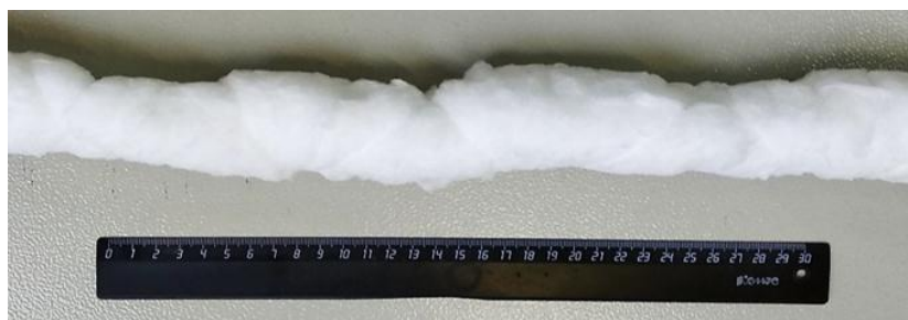
Рис. 5. Внешний вид заготовки шнура после высокотемпературного обжига
