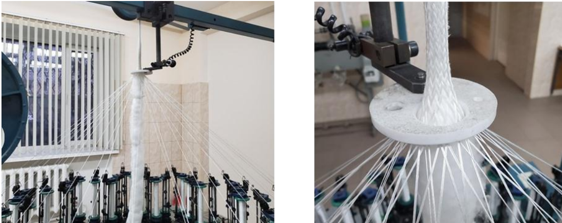
Рис. 7. Оплетка шнура кварцевыми нитями на шнуроплетельной машине
