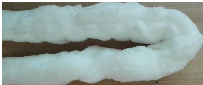
Рис. 6. Заготовка термообработанной сердцевины после перегиба на 180 градусов без разрыва волокна
