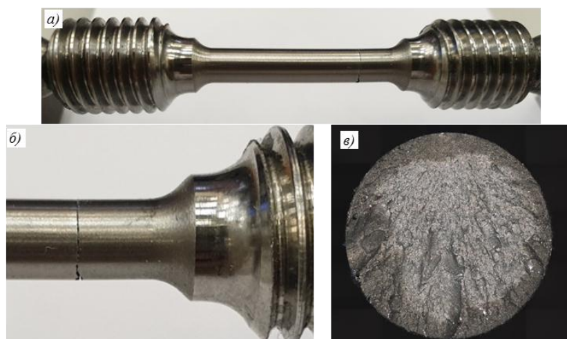
Рис. 4. Общий вид образца 4 (а), область разрушения (б) и поверхность разрушения (в)
