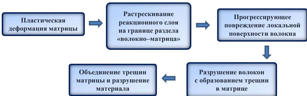
Рис. 4. Схема разрушения волокнистого МКМ системы Ti–SiC при уровне напряжений 0,75\sigma_b
