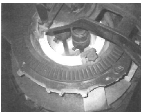
Рис. 1. Шток поршня, изготовленный из сплава Incoloy MA 956, для подачи стекломассы и работающий при температуре 1200 °С [8]
