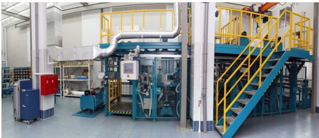
Рис. 2. Установка по изготовлению калиброванных прецизионных препрегов Coatema VL-2800 (Германия)
