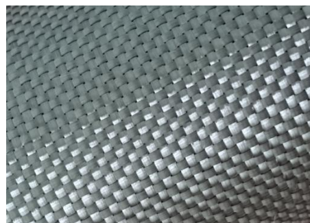
Рис. 3. Углеродная равнопрочная ткань полотняного плетения марки ВТкУ-7 с поверхностной плотностью 585 г/м 2
