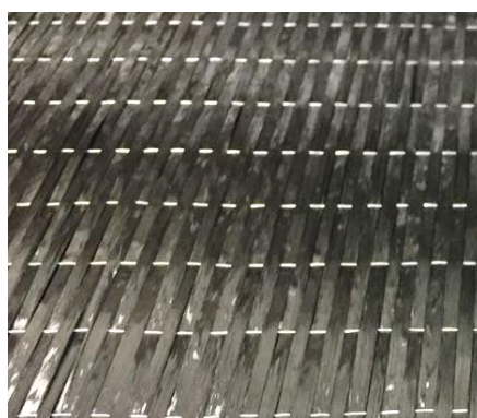
Рис. 4. Углеродная однонаправленная ткань полотняного плетения марки ВТкУ-3.290 с поверхностной плотностью 290 г/м 2
