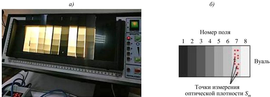
Рис. 5. Сенситограммы испытываемой радиографической пленки (а); топография измерения оптической плотности полей сенситограммы (б)
