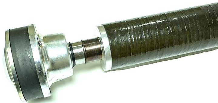
Рис. 3. Вал из углеродного волокна, изготовленный методом намотки [21]
