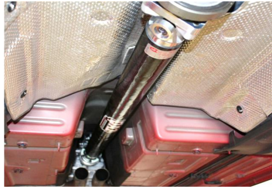
Рис. 2. Установленный на автомобиль композитный карданный вал [18]
