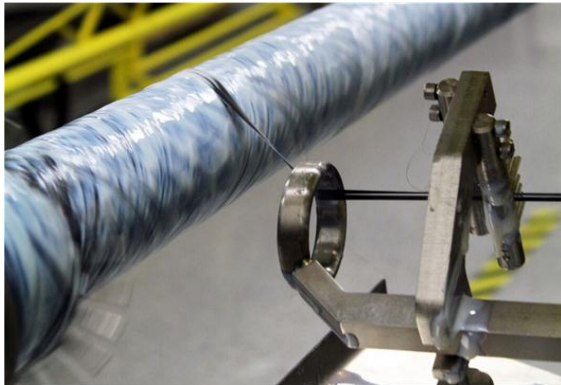
Рис. 1. Процесс намотки заготовки карданного вала из ПКМ [18]
