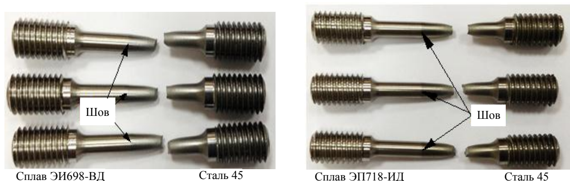
Рис. 9. Внешний вид образцов после проведения механических испытаний на растяжение
