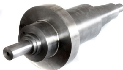
Рис. 4. Сварная заготовка вала ротора турбокомпрессора после механической обработки
