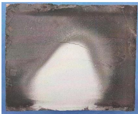
Рис. 4. Образец теплозащитного покрытия типа ВШ-27Ф с Антипиреном 2 после воздействия пламени с температурой 1100 °С в течение 15 мин
