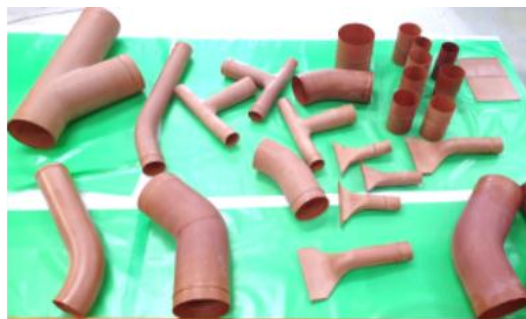
Рис. 6. Элементы системы кондиционирования воздуха из стеклопластика
