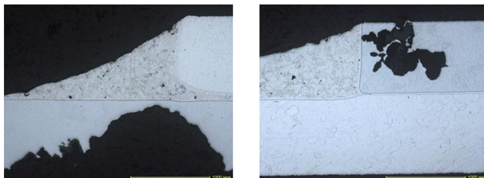
Рис. 7. Микроструктура паяных соединений образцов соединения сталей 12X18H10T–ЭИ961, выполненных припоем ВПр50, после выдержки в камере солевого тумана в течение 6 мес
