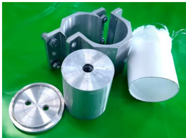
Рис. 8. Манжета гибкого трубопровода и оснастка для ее изготовления
