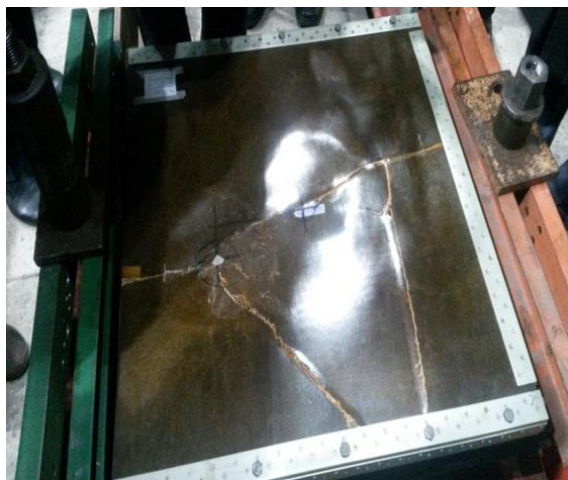
Рис. 2. Вид конструктивно-подобного образца закрылка, не защищенного органопластиком, после ударного воздействия
