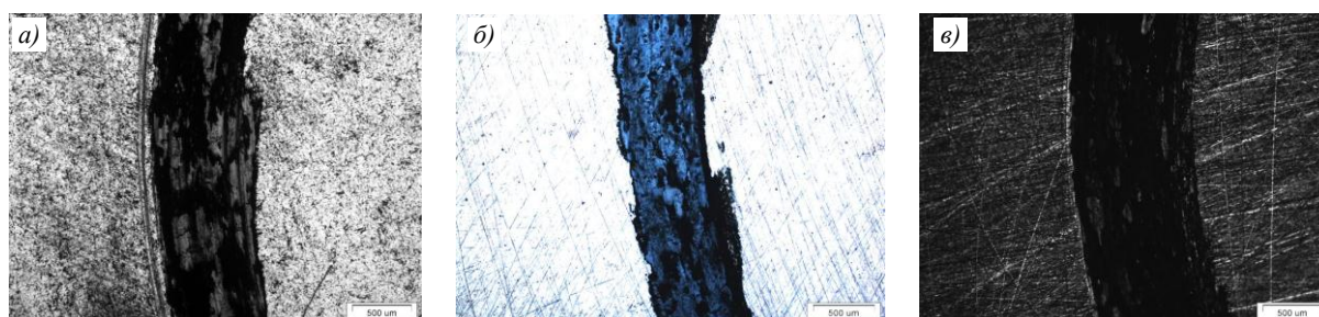
Рис. 5. Микроструктуры ( \times 50 ) дорожек износа после испытания на изнашивание в условиях сухого трения сталей марок ВНС9-Ш (а), ВНС30-Ш (б) и ВНС72-Ш (в)
