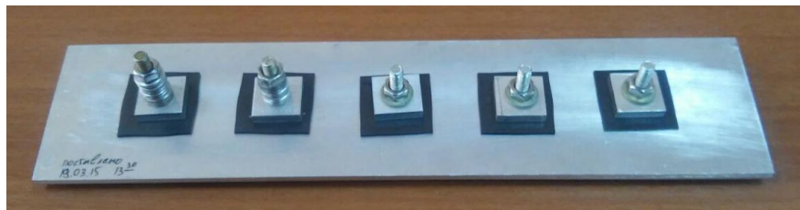
Рис. 1. Болтовое соединение, моделирующее условия работы материала марки ВТП-1В в нервюре крыла
