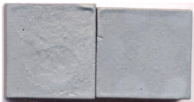
Рис. 3. Внешний вид магнитов системы РЗМ–Fe–В после обдувки сухим сжатым воздухом
