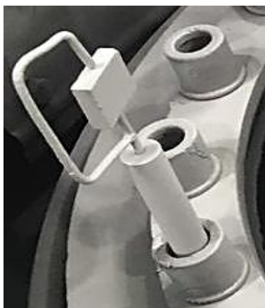
Рис. 5. Внешний вид образца магнита системы РЗМ–Fe–В после нанесения покрытия системы СДП-1Т + ВСДП-13
