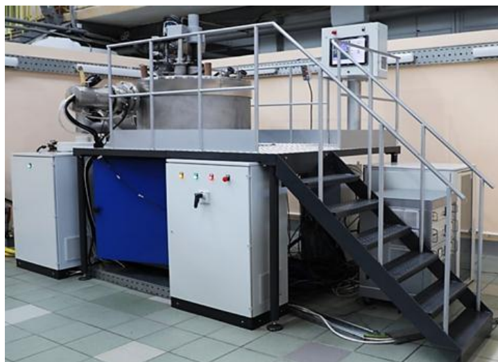
Рис. 1. Внешний вид промышленной ионно-плазменной установки МАП-3 для вакуумно-дугового нанесения покрытий
