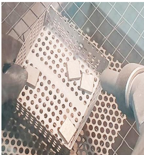
Рис. 2. Внешний вид образцов во время обдувки электрокорундом
