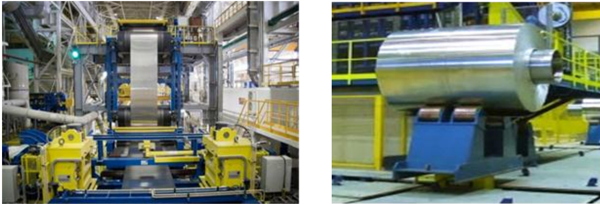
Рис. 1. Линия непрерывной термической обработки и внешний вид рулона из сплава В95п.ч.
