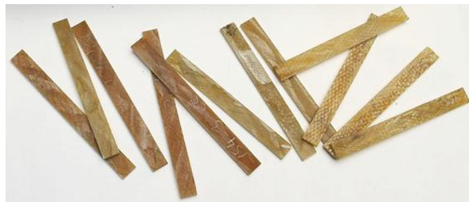
Рис. 2. Образцы для определения температуры стеклования стеклопластика
