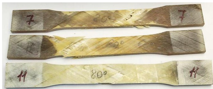
Рис. 4. Образцы для определения механических свойств стеклопластика
