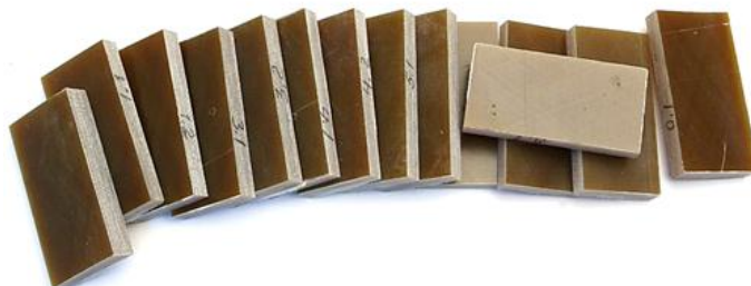
Рис. 3. Образцы для определения физических свойств стеклопластика
