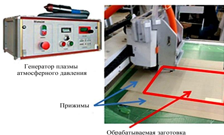
Рис. 4. Обработка обшивок с помощью генератора плазмы атмосферного давления
