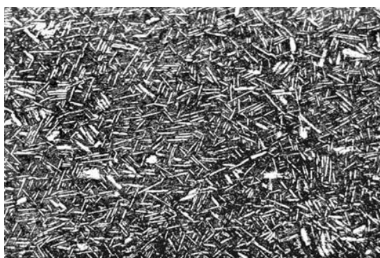
Рис. 4. Микроструктура ( \times 600 ) плит из сплава ВИТ1 после термической обработки
