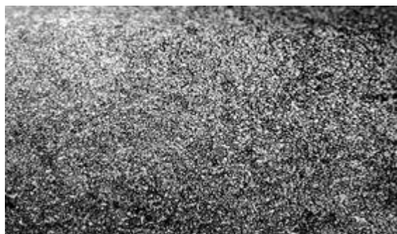
Рис. 2. Микроструктура ( \times 500 ) плиты из сплава ВИТ1 после горячей деформации
