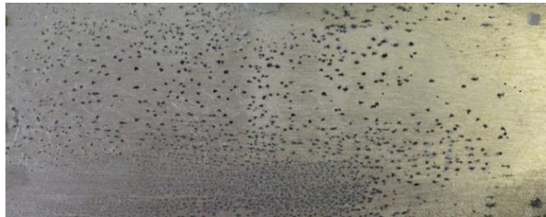
Рис. 8. Внешний вид образца из алюминиевого сплава В95 после выдержки на его поверхности смеси смывок
