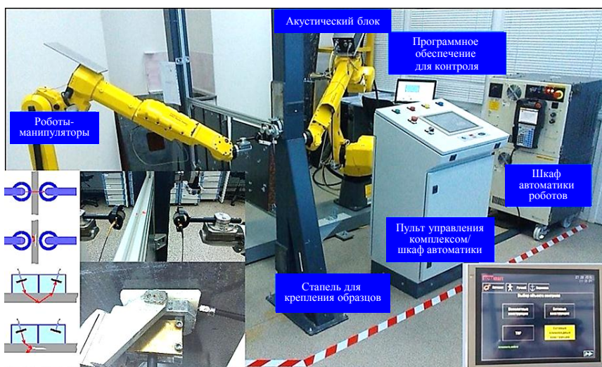
Рис. 3. Макет автоматизированного комплекса для ультразвукового неразрушающего контроля качества деталей и агрегатов из ПКМ
