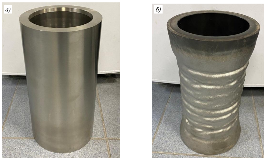
Рис. 1. Катод из сплава ВСДП-3 до эксплуатации (а) и после выработки ресурса (б)
