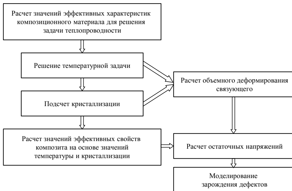
Рис. 3. Алгоритм оценки остаточных напряжений в термопластичном композиционном материале
