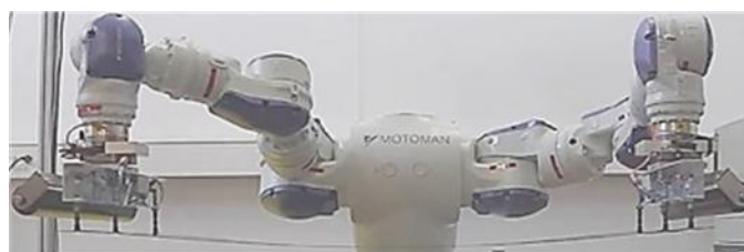
Рис. 11. Прогиб препрега при захвате его длинного слоя
