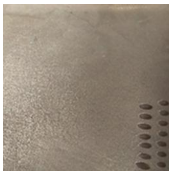
Рис. 1. Внешний вид поверхности фрагмента сопловой лопатки из сплава марки ЖС6У после эксплуатации
