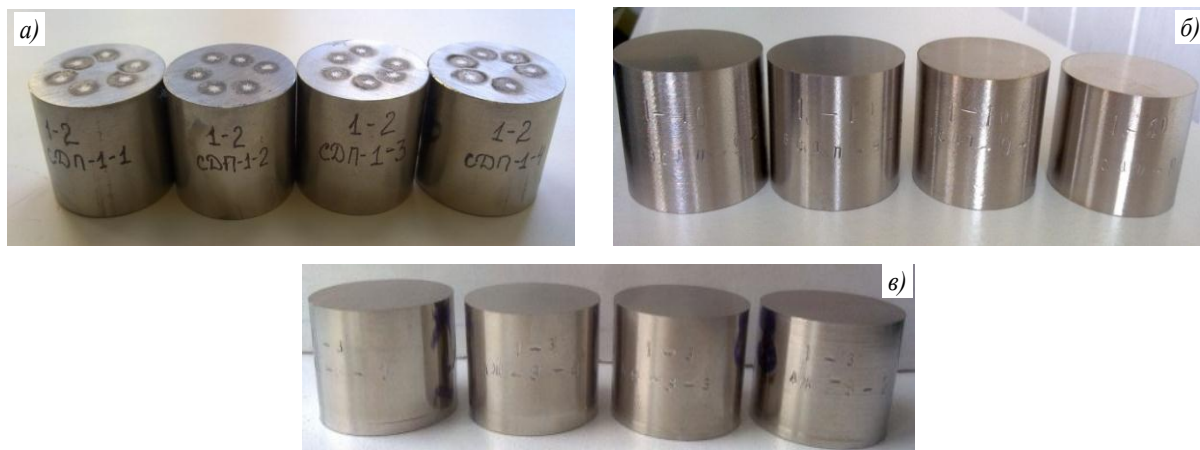
Комплекты стандартных образцов никелевых сплавов марок СДП-1 (а), ВСДП-9 (б) и АЖ-8 (в)
