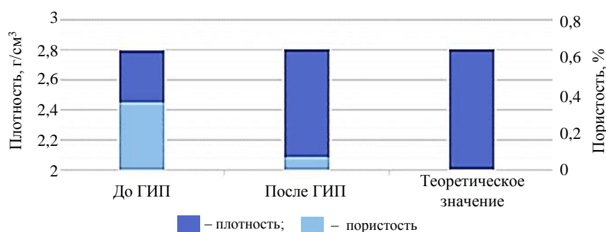
Рис. 4. Результаты измерения плотности и пористости образцов из сплава системы Al–Zn–Mg–Cu–Ni–Fe, полученных литьем в кокиль
