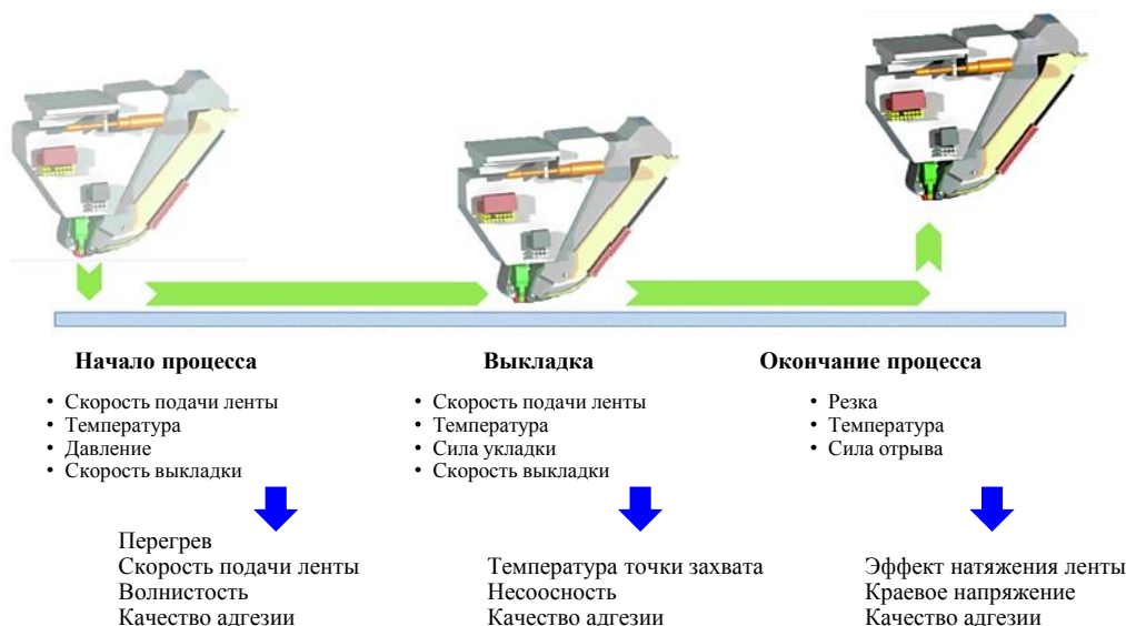
Рис. 1. Распространенные проблемы во время процесса выкладки волокон при использовании технологии AFP
