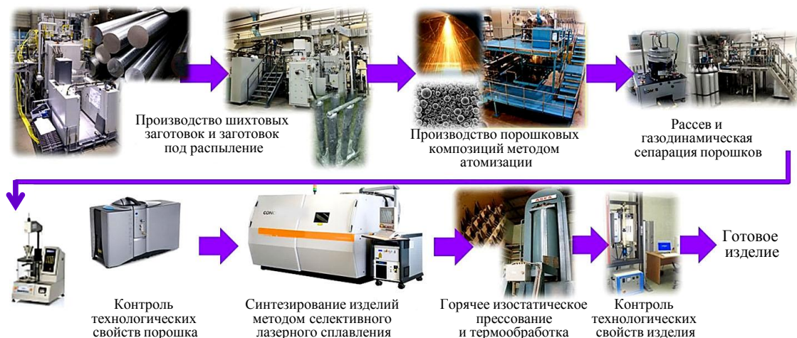
Рис. 1. Схема изготовления изделий с использованием аддитивных технологий
