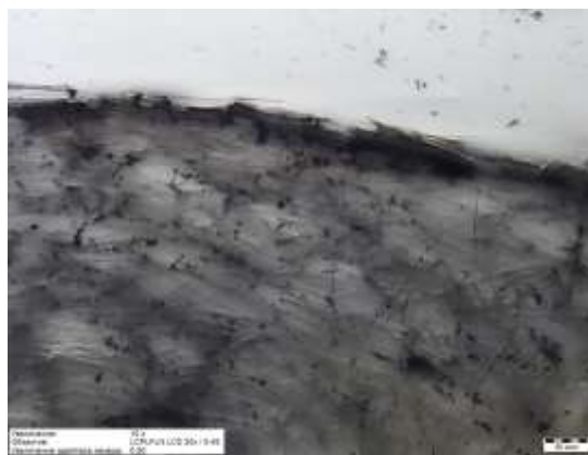
Рис. 8. Микроструктура тонкого среза образца материала типа Б до высокотемпературного обжига
