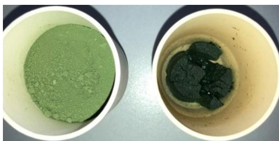
Рис. 3. Шихта для варки эмали ЭВ-300-60М до (а) и после прокаливания при температуре 1100 °С (б)
