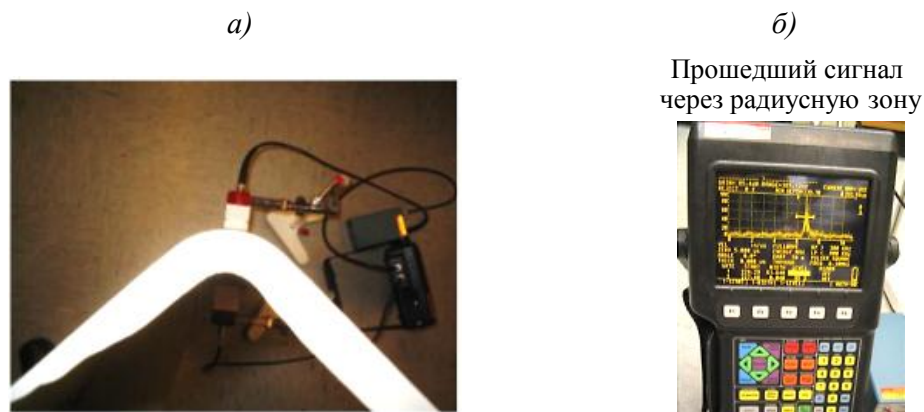
Рис. 9. Размещение преобразователей на специальной оправке в радиусной зоне и демонстрация прошедшего ультразвукового сигнала
