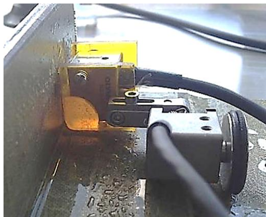
Рис. 16. Оправка для секторной фазированной решетки со вставкой из аквалена
