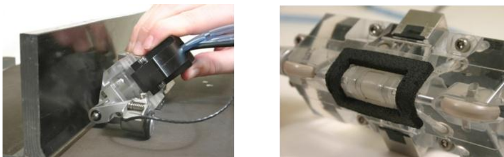
Рис. 15. Секторная фазированная решетка в корпусе локальной иммерсионной ванны
