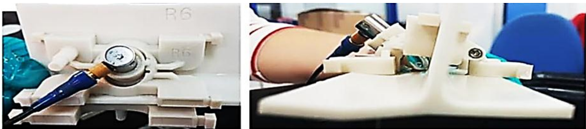
Рис. 5. Расположение специальной оправки для ультразвукового контроля на фрагменте лонжерона
