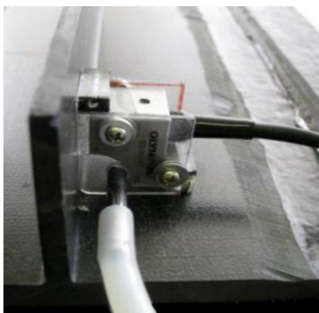
Рис. 11. Секторная фазированная решетка с локальной иммерсионной ванной
