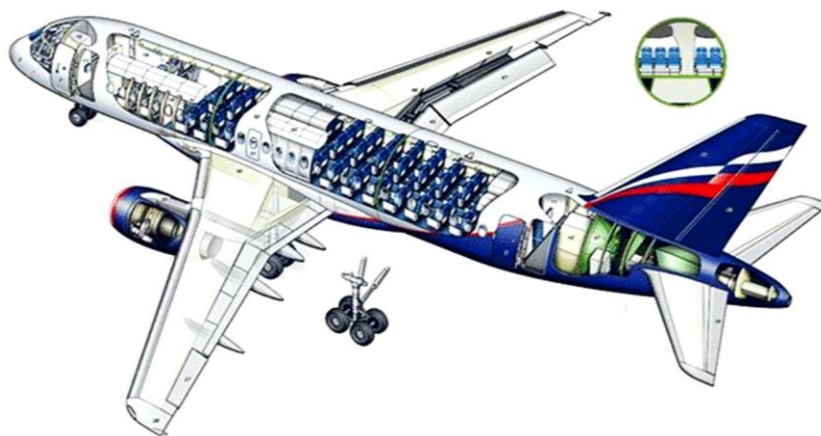
Рис. 1. Схема конструкции пассажирского салона самолета
