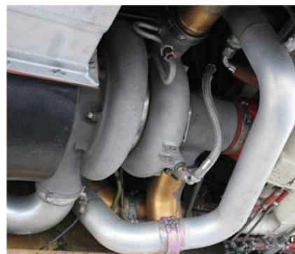
Рис. 3. Элементы воздухопроводов системы кондиционирования воздуха
