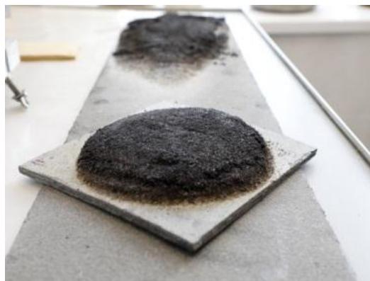
Рис. 1. Внешний вид образца огнезащитной пасты ВЗО-9х после испытаний
