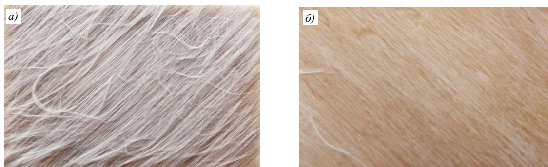
Рис. 4. Макроструктура поверхности образца из стеклопластика ВПС-53/Р-1200 с лицевой (а) и оборотной (б) сторон после 5 лет климатических испытаний
