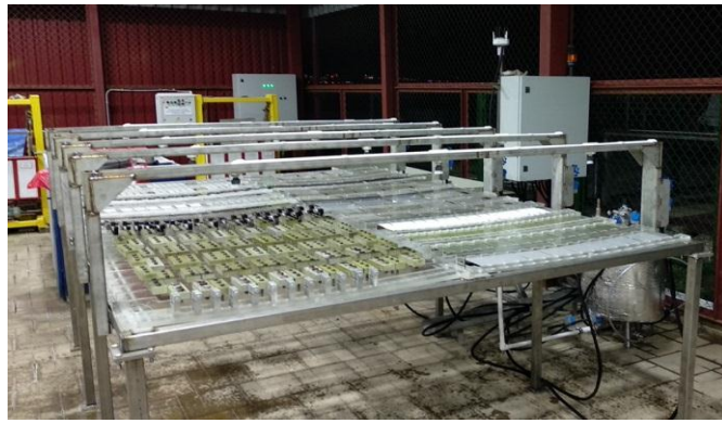
Стенд автоматического орошения морской водой в ГЦКИ ВИАМ
