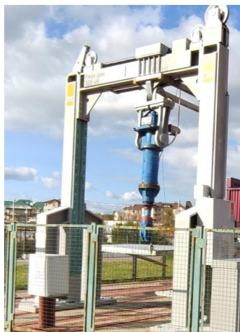
Стенды ГЦКИ ВИАМ для испытаний крупногабаритных конструкций на силовом полу, изготовленные по техническому заданию ФГУП «ВИАМ»
