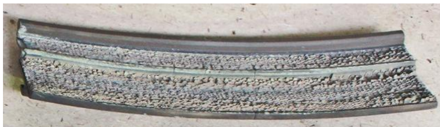
Рис. 1. Сотовое уплотнение после эксплуатации в составе газотурбинного двигателя
