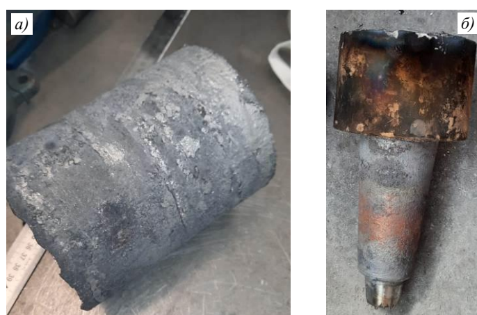
Рис. 2. Слитки из сплава системы Fe–Cr–Al–Y после вакуумного дугового переплава диаметром 130 мм (а) и вакуумно-индукционного переплава с равноосной кристаллизацией с неснятой прибыльной надставкой (б)
