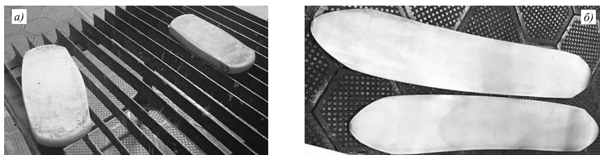
Рис. 6. Сутунки (а) и горячекатаные листы толщиной 3–4 мм (б) из жаростойкого сплава системы Fe–Cr–Al–Y
