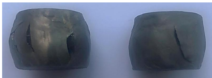
Рис. 5. Продольные трещины на поверхности образцов из слитка вакуумно-дугового переплава сплава системы Fe–Cr–Al–Y после осадки
