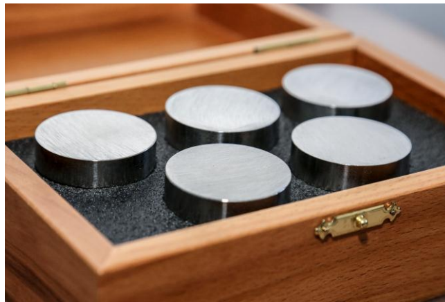
Рис. 3. Внешний вид стандартного образца состава сплава ЖС6К
