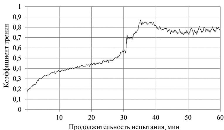
Рис. 9. Кинетика изменения коэффициента сухого трения скольжения образцов из стали ВНС32-ВИ, обработанных по схеме «закалка + ОХ + ДТ + ИА»
