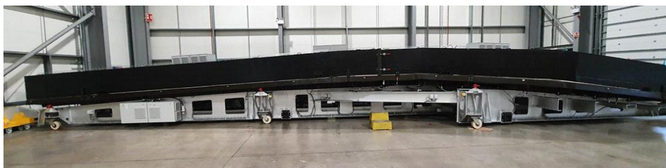
Рис. 5. Оснастка из углепластика для изготовления обшивки крыла с индивидуальной системой нагрева заготовок деталей по зонам
