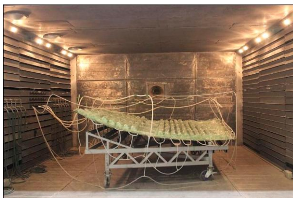
Рис. 6. Формование в термопечи обшивки крыла самолета MC-21 [19]
