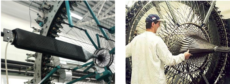
Рис. 6. Процесс изготовления конструктивно-подобного образца лопасти воздушного винта
