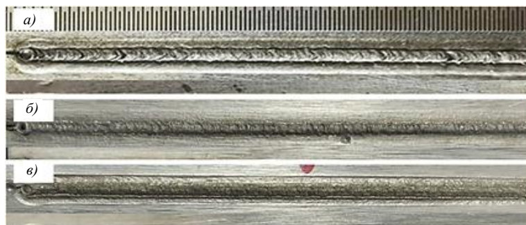
Рис. 9. Морфология поверхностей сварных швов, выполненных лазерной сваркой (а), лазерной сваркой с прослойкой из титана (б) и ультразвуковой лазерной сваркой с прослойкой из титана (в) [22]
