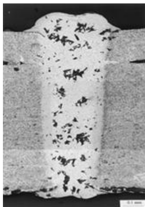
Рис. 4. Микроструктура сварного шва алюминиевого сплава 6061, армированного 20 % (объемн.) частиц SiC [20]
