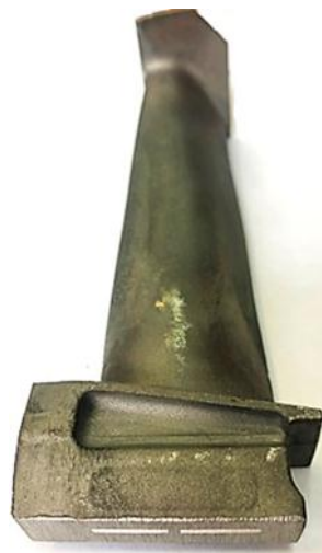
Рис. 3. Общий вид отливки турбинной лопатки с керамическим стержнем из плавленного кварца
